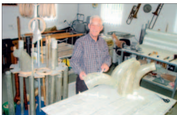
In seiner Keller-Werkstatt „klebt“ Lorenz Klostermair Alphörner: Becher und Rohre der 3,60 Meter langen Instrumente werden aus Fieberglas-Matten gewickelt und mit Harz gehärtet – eine Methode, die vermutlich einzigartig ist. Klostermairs Alphörner sind nur 2,5 Kilogramm schwer (ein Holz-Alphorn wiegt dreimal so viel) und zudem wetterbeständig.
